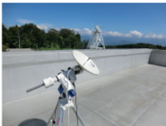
完成した物を組み合わせて電波が捉えられるか屋外にてテストしている様子
