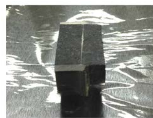
図4 膨潤変形した試料。黒色の岩石に挟まれた白い層が試料で、切断時の吸水により膨張し、切断面より盛り上がっている。
