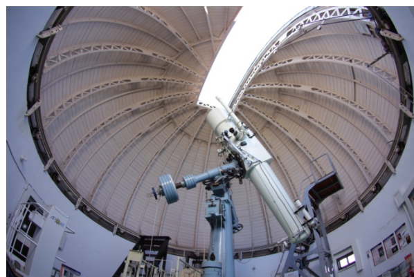
図-4 本館 45cm 屈折望遠鏡
