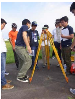
GPS観測の三脚の設置法指導
