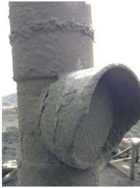
カメラハウジング表面に付着した火山灰の除去
