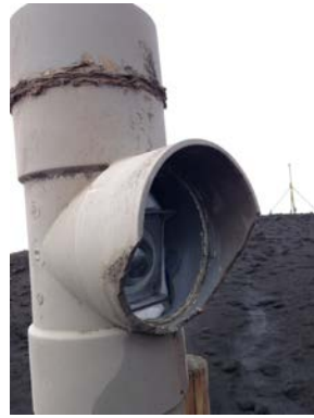
カメラハウジング表面に付着した火山灰の除去
