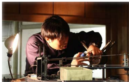
ウィヘルト地震計の修復作業
