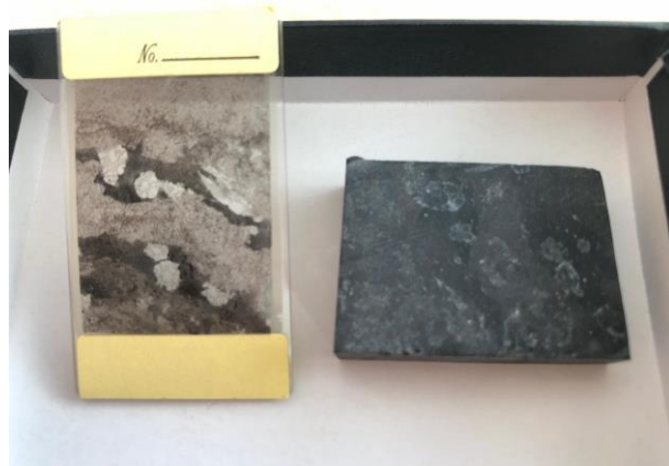
完成した薄片と切り出した岩石片
