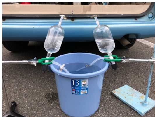
図 2：真空採気瓶を使った溶存ガス採取の検討
