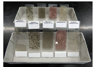
エディンバラ大学で作製した薄片(手前)と研磨薄片(奥)。薄片、研磨薄片のスライドガラスの大きさは、それぞれ75×25 mm、48×25 mm。
