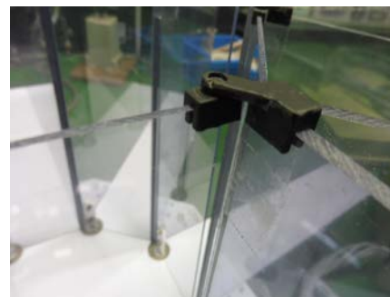
図 3 3D プリンタで振止を製作
