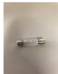
図 7 ヒューズ破損
