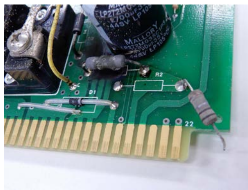
写真2 焼けた抵抗R1と外れた抵抗R2
