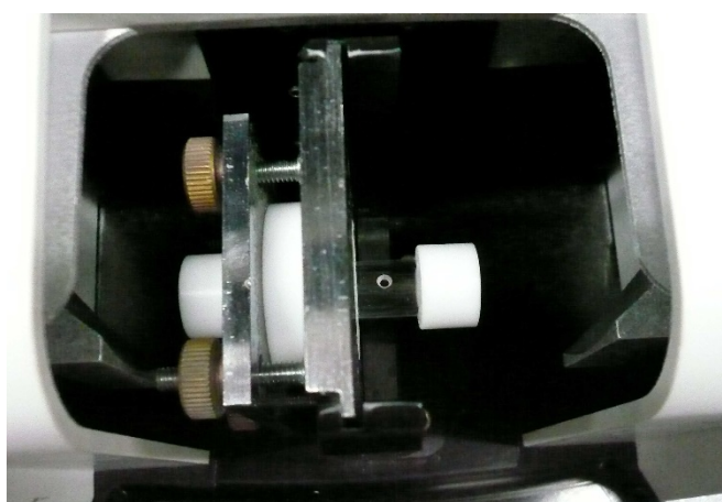
図1. これまで使用していた部品を分光器にセットしたところ 両端のアダプタが固定されておらず、外れやすい
