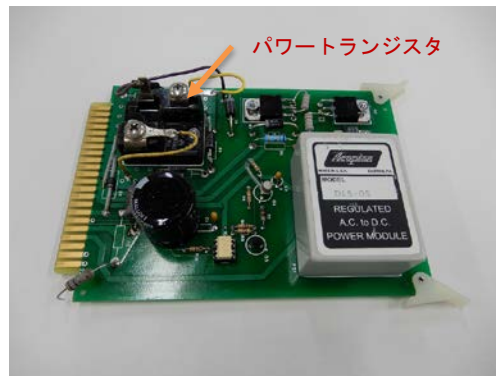
写真1 故障したアークパルサーボード
