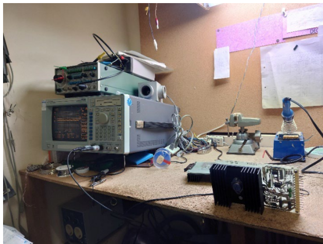
図-6 モータ駆動用アンプボードの修理
