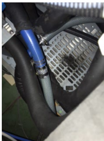
写真3 純水チラーのポンプ位置でホース配管を延長して機外に取り出し
