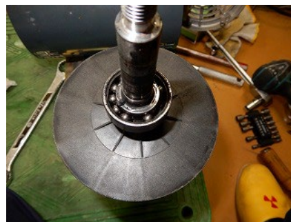
写真2 保持器が外れ壊れた玉軸受け
