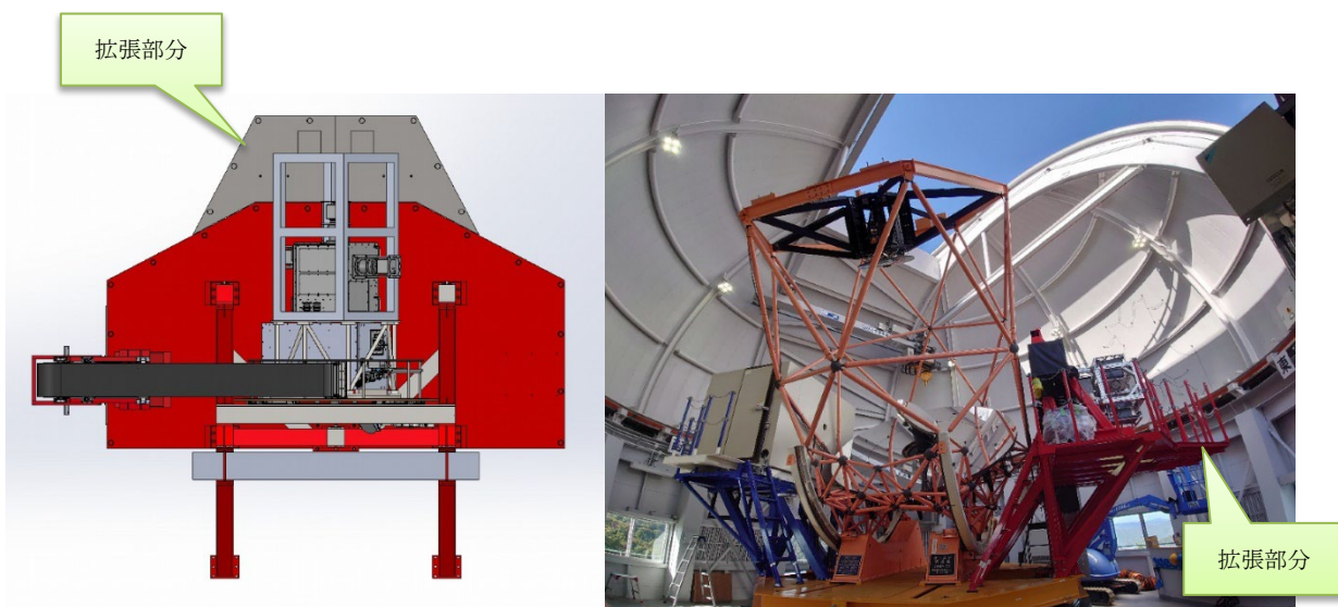
図-4 ナスミス台拡張 (左：設計上面図、右：製作、取付後)
