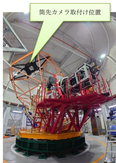
図-4 筒先カメラの取付け位置
