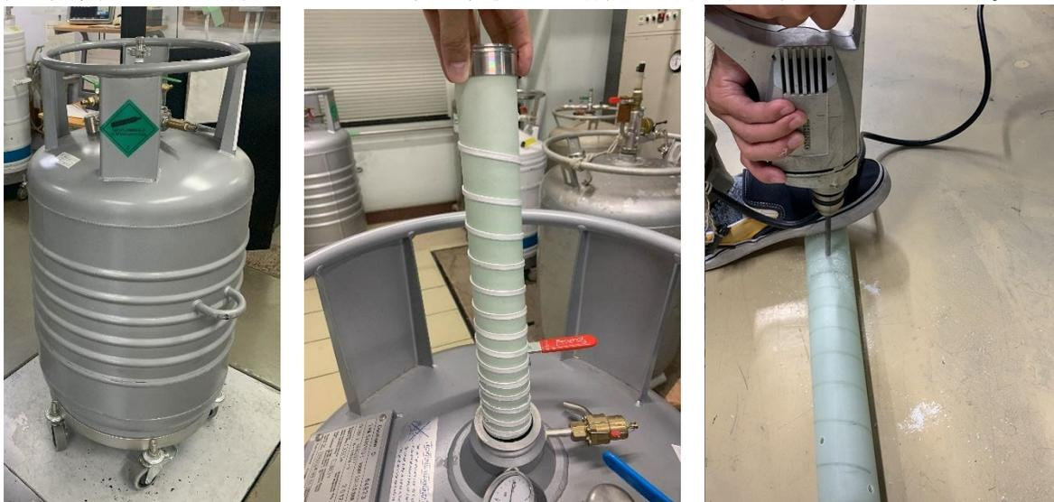
改修した 100 L 容器外観(左)、取り出したネック部(中央)、テフロンを外した筒へのピッチ調整をした穴あけ加工(右)。中央の写真の中央下端に半分見えているのが圧力計。穴のピッチはリボンのピッチと逆で、上側ほど短くした。
