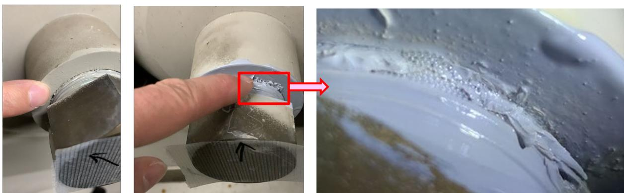
ガスボンベのボトムへの液状ガスケット塗布前(左)と塗布後(中央)、およびひび割れ隙間への発泡液浸透で生じるカニ泡(右)
