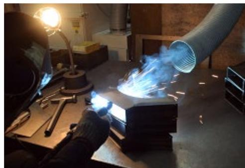
図4 集塵機使用例写真、株式会社淀川電機製作所カタログより引用
