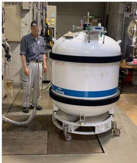
凍結で破れた薄肉銅管(左)と、逆トランスファーに用いた 450 L 容器(右)
